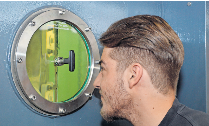
Prüfender Blick: Lehrling Dominik Gottschlich beobachtet einen Dichtigkeits-test im Wasserbecken der Firma Neumann & Esser.
